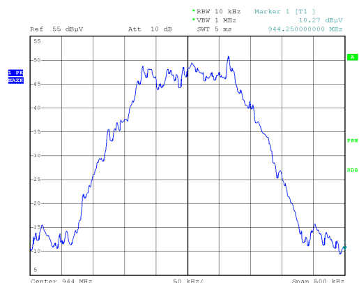
Figur A.6: Et typisk GSM-900 signal. Vanskelig ut fra nivået og krueformen å si om det er refleksjoner og om nivået er påvirket av lokale refleksjoner.
