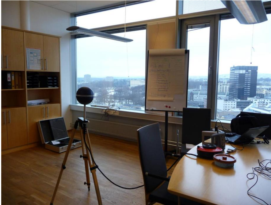
Figur 6.3: Måleutstyret satt opp for måling i et kontormiljø. Foto: Øystein Sølvberg, Post- og teletilsynet.
