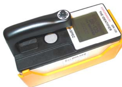
Håndinstrument som brukes for å kontrollere funn av radioaktivt materiale (Foto: Statens strålevern).
