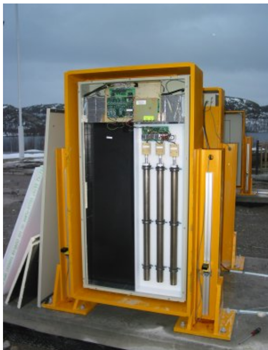
Deler av en detektorportal, med deteksjonsinstrumentene synlige (Foto: Statens strålevern).
