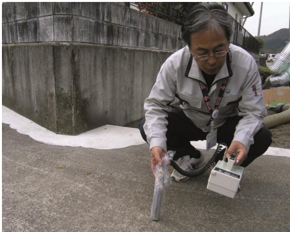
Måling av oppkjørsel etter at den har blitt sandblåst. I byen Date, Japan. Foto: Statens strålevern
