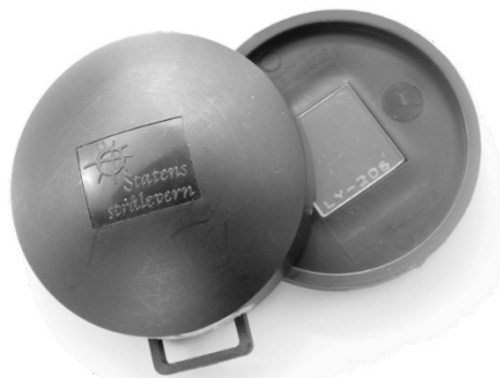
Figur 2: Radondetektorer fra Independia AB og Statens strålevern. Detektoren fra Strålevernet er åpnet og viser sporfilmene inne i detektoren. Foto: Statens strålevern.
