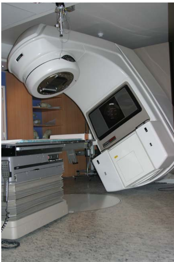
Figur 3 Linac, gantry med akseleratorhode og behandlingsbenk for pasient til venstre.
