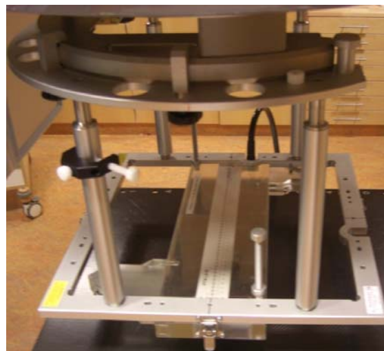
Figur 4 Diodearray montert på akseleratorhodet
