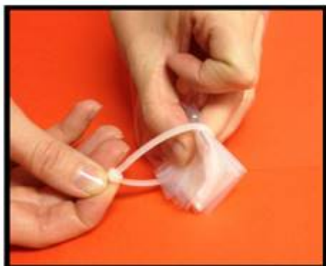
Figur 1: Forsegling av rilsanpose ( Kundeinstruks – forsegling av rilsanpose; ALS )
