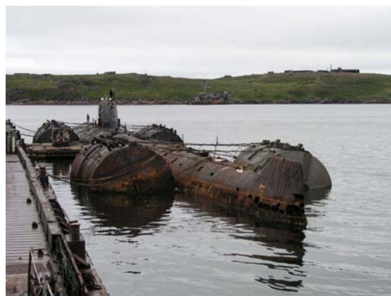
Figur 5: K-159 ved kai straks før slepet. Fire pongtonger er festet til båten. (Foto: den russiske Nordflåten)
