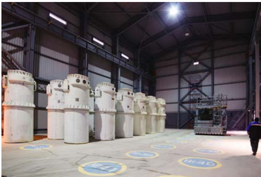
Det brukte kjernebrenselet skal plasseres i transport- og lagringsbeholdere som holder internasjonal standard. (Foto: SevRAO).
