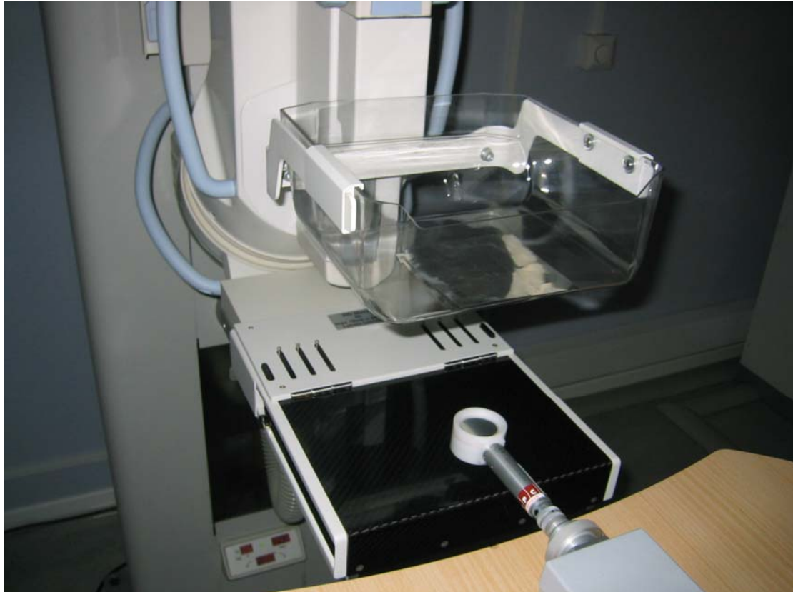
Figur 3 Oppsett for å måle halvverdilaget (HVL) med ionekammer.
