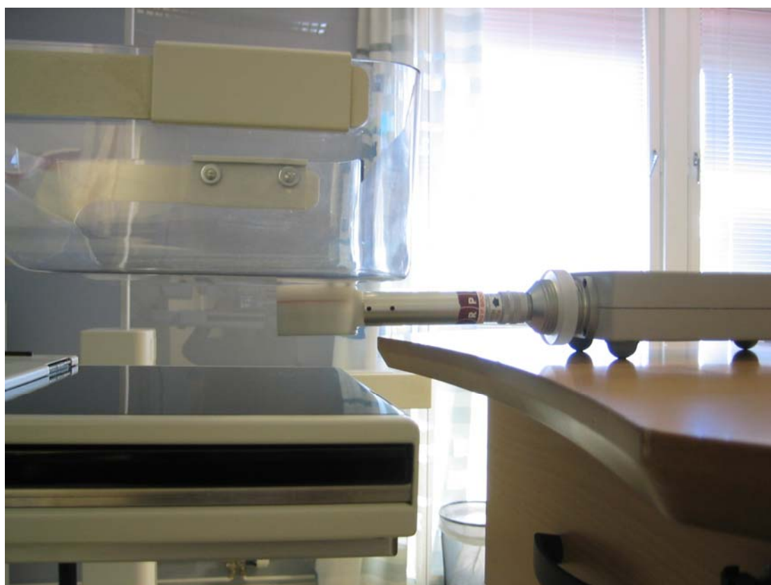
Figur 2 Oppsett for å måle stråleutbytte med ionekammer.
