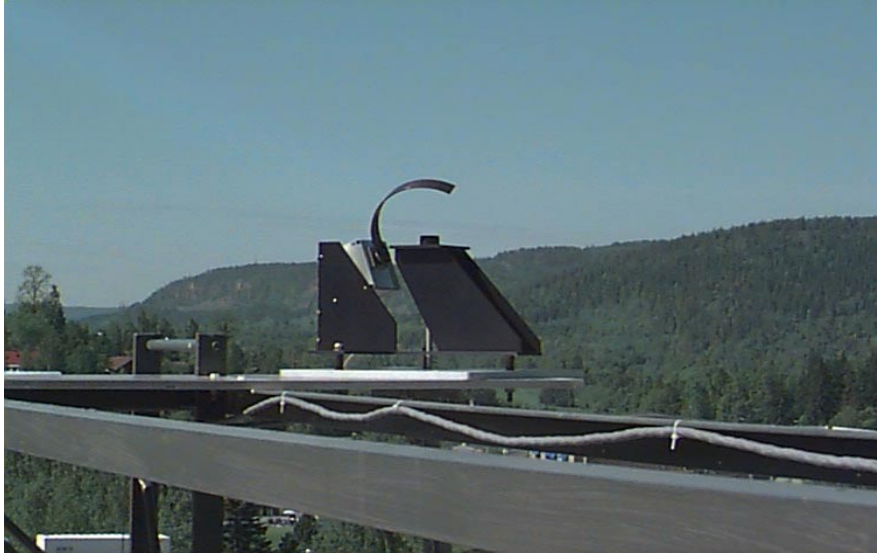
Figur 3. Inngangsoptikken til Bentham DM 150 med skyggebånd. Skyggebåndet har lokalisert solen og foretar en måling av diffust spredt stråling.
