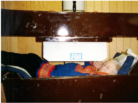
Figur 9: Måling av kroppens innhold av cesium-137 i Kautokeino med innleid utstyr fra FOA (i 1996).
