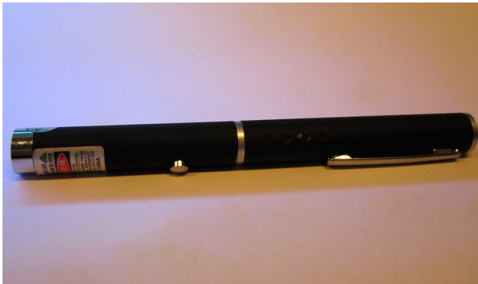
En laserpeker av klasse IIIb med typisk utforming og advarselsmerking etter amerikansk standard. (Foto: Tommy Nakken Aalerud, Strålevernet)
