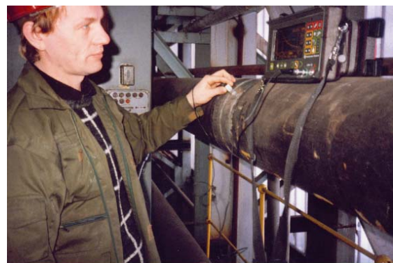
Inspeksjon ved hjelp av moderne ultralydteknikk på Kola kjernekraftverk (Foto: IFE).
