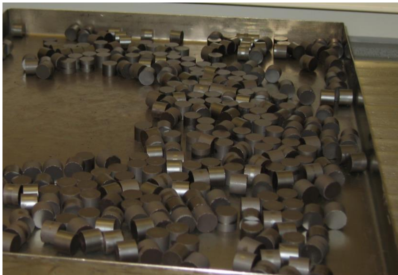
Figur 7.3. Brenselspelleter klare til å monteres til brenselspinner. Foto: Statens strålevern.
