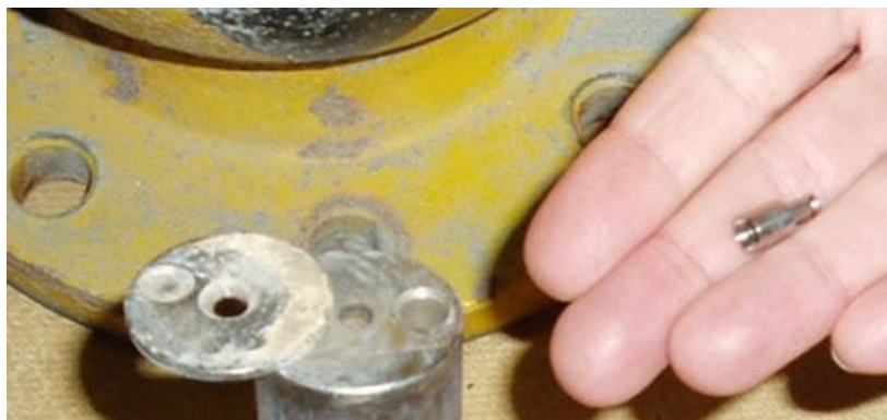
Figur 5.1 Bildet viser en hvordan en kildekapsel kan se ut. Kilden på bildet er en illustrasjonskilde, en «dummy», dvs. at kapselen ikke inneholder radioaktivt stoff. Foto: Statens strålevern.
