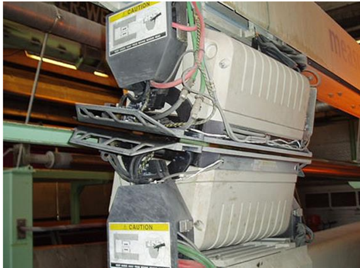
Figur 5.6 I papirindustrien benyttes bl.a. promethium-147, en beta-emitter, som kilde for å måle tykkelsen på papiret. I slike apparater går papiret fritt mellom enhetene og målingen blir utført kontinuerlig. Foto: Statens strålevern.
