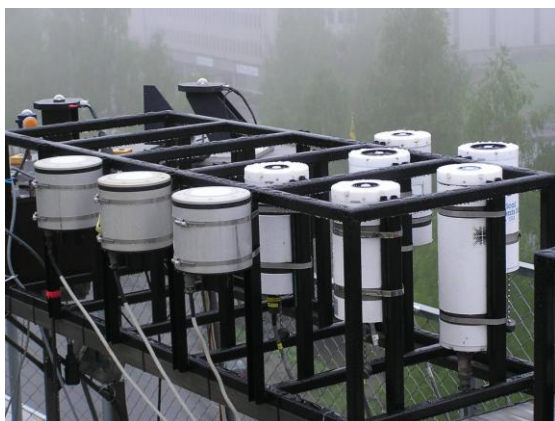
Foto 2-3 Flerkanals instrumenter av typen NILU-UV (foran til venstre) og GUV (til høyre). GUV-instrumenter benyttes i det norske UV-nettverket. I bakgrunnen ses inngangsoptikken til tre spektralradiometre.
