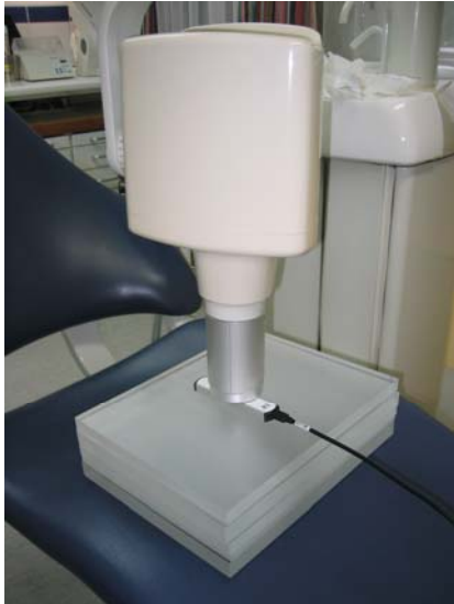
Figur 1 Måleoppsett for måling av kV, eksponeringstid og dose. Måleutstyret på figuren er Unfors Xi.
