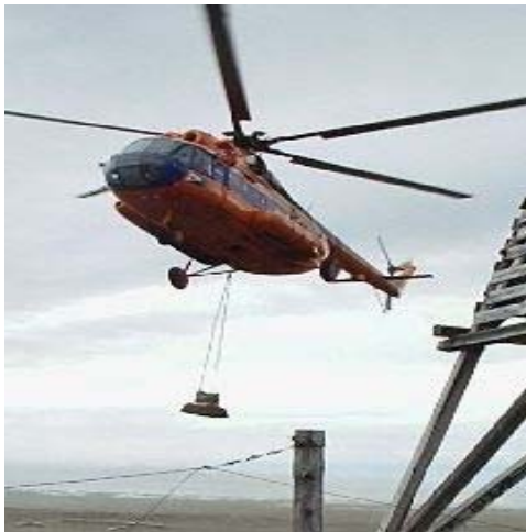
Рис. 7. Транспортирование демонтированных РИТЭГ с мест установки до береговой черты, обеспечивающее возможность их погрузки на плашкоут.
