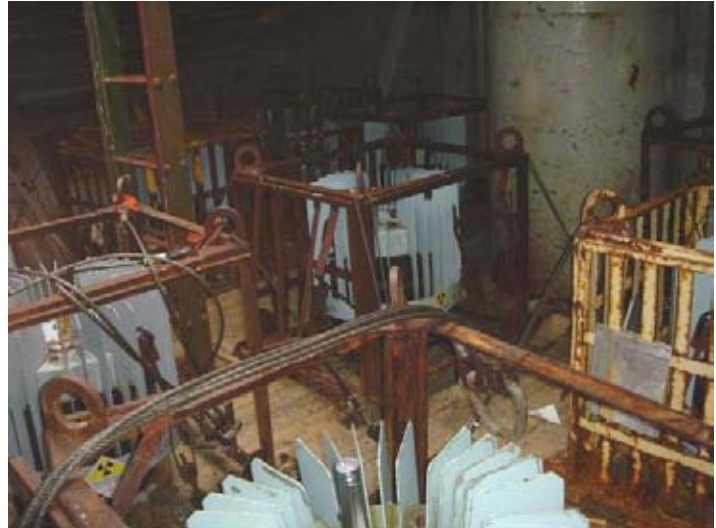
Рис. 6. Разгрузка плашкоута от РИТЭГ с помощью судового крана. РИТЭГ размещаются и закрепляются в трюме судна или на палубе, в местах наиболее отдаленных от мест постоянного или временного пребывания команды судна
