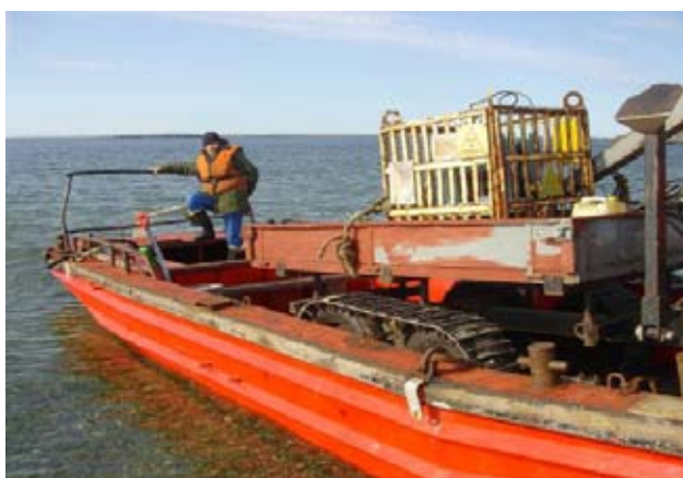
Рис. 4. Размещение упаковки с демонтированным РИТЭГ на плашкоуте (для доставки на судно). На плашкоуте должно находиться минимальное число персонала.
