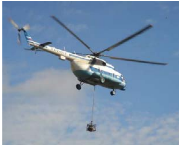
Рис. 7. Транспортирование демонтированных РИТЭГ с мест установки до береговой черты, обеспечивающее возможность их погрузки на плашкоут.
