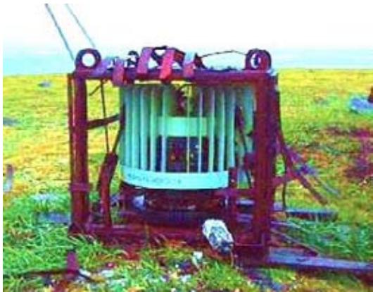
Рис.1. Обследование РИТЭГ на месте эксплуатации с целью решения вопроса о возможности его транспортирования (контроль за мощностью дозы гамма-излучения на поверхности РИТЭГ, на расстоянии 1 м от поверхности РИТЭГ, а также контроль состояния охранной тары).
