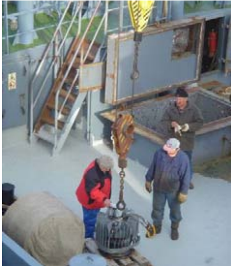
Рис. 6. Разгрузка плашкоута от РИТЭГ с помощью судового крана. РИТЭГ размещаются и закрепляются в трюме судна или на палубе, в местах наиболее отдаленных от мест постоянного или временного пребывания команды судна
