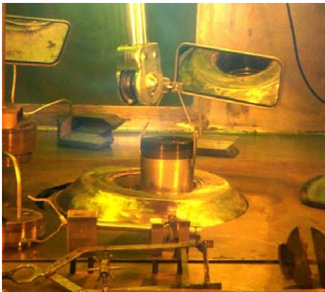
Рис. 9. Перегрузка РИТ из РИТЭГ в транспортные контейнеры в «горячей камере» в ФГУП ВНИИТФА
