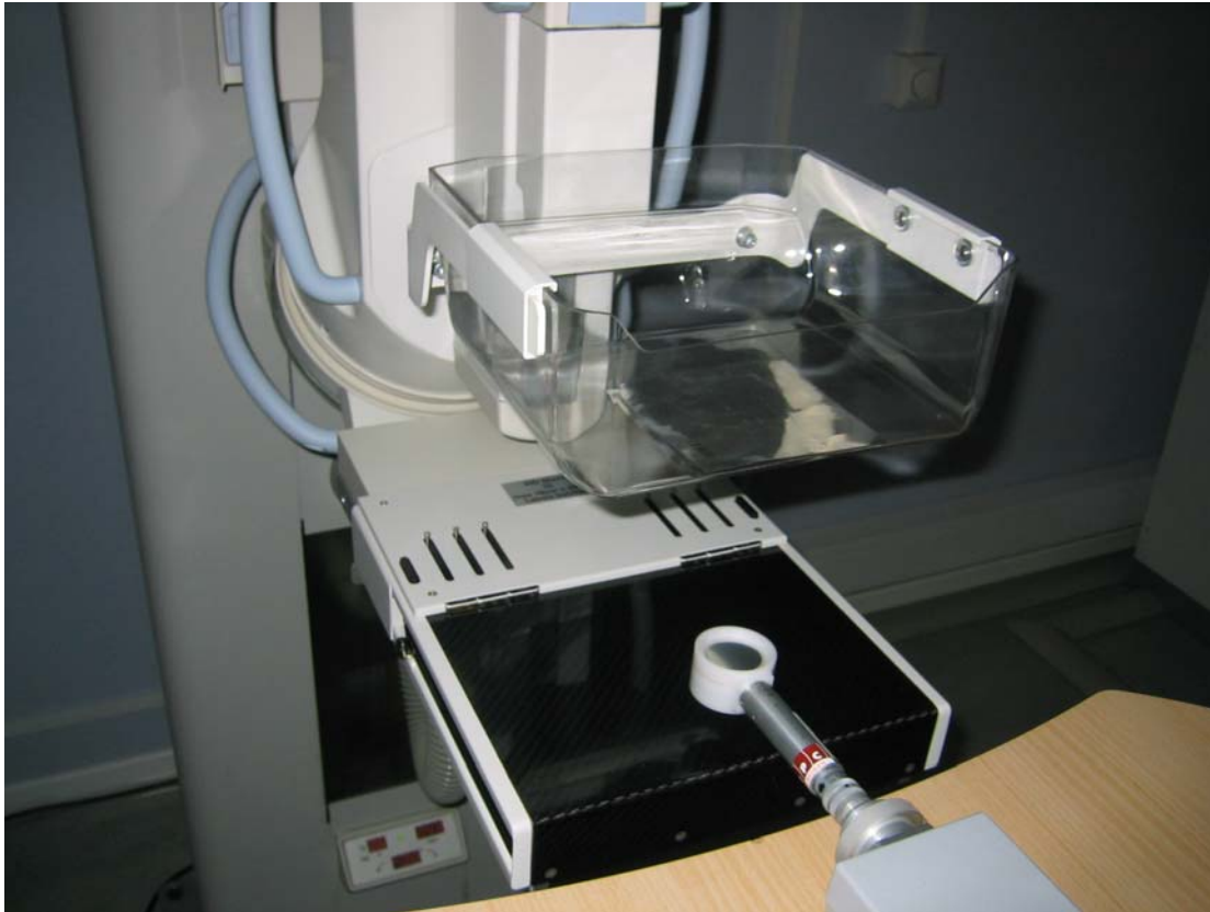
Figur 2 Oppsett for å måle halvverdilag (HVL) med ionekammer.
