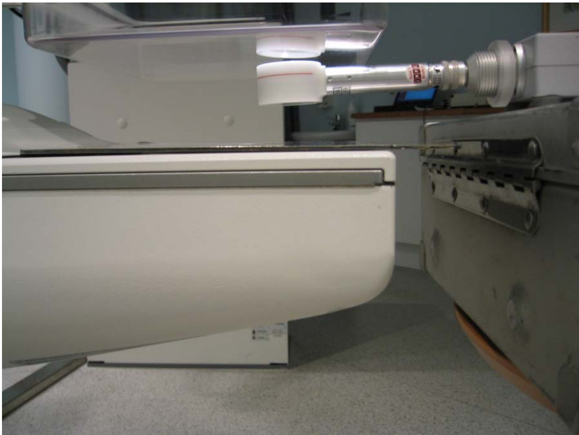
Figur 1 Oppsett for å måle stråleutbytte med ionekammer. Eksempelet viser måling på et digitalt mammografisystem. Objektbordet er derfor dekket av ei stålplate for å unngå problemer med såkalt "ghost images".
