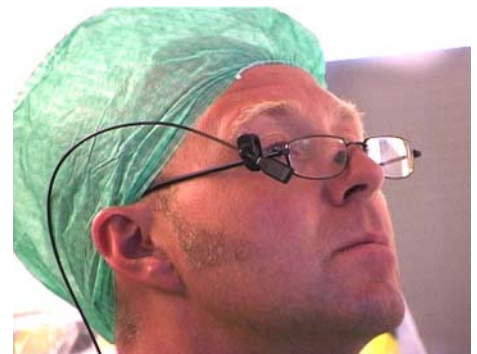
Figur 2 EDD detektoren fra Unfors, og plassering av denne ( www.unfors.se )
