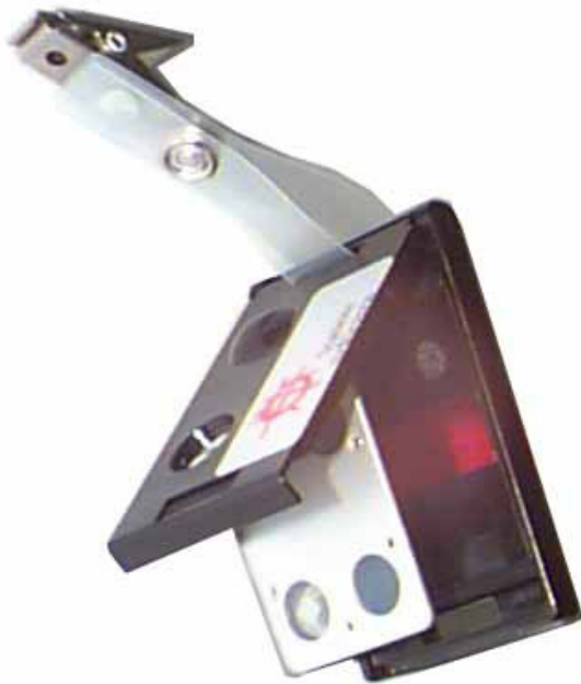
Figur 1. Dosimeterkortet plassert i holderen.
