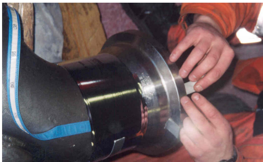
Figur 10. Industriell radiografi ved kontroll av sveiser i rør.
