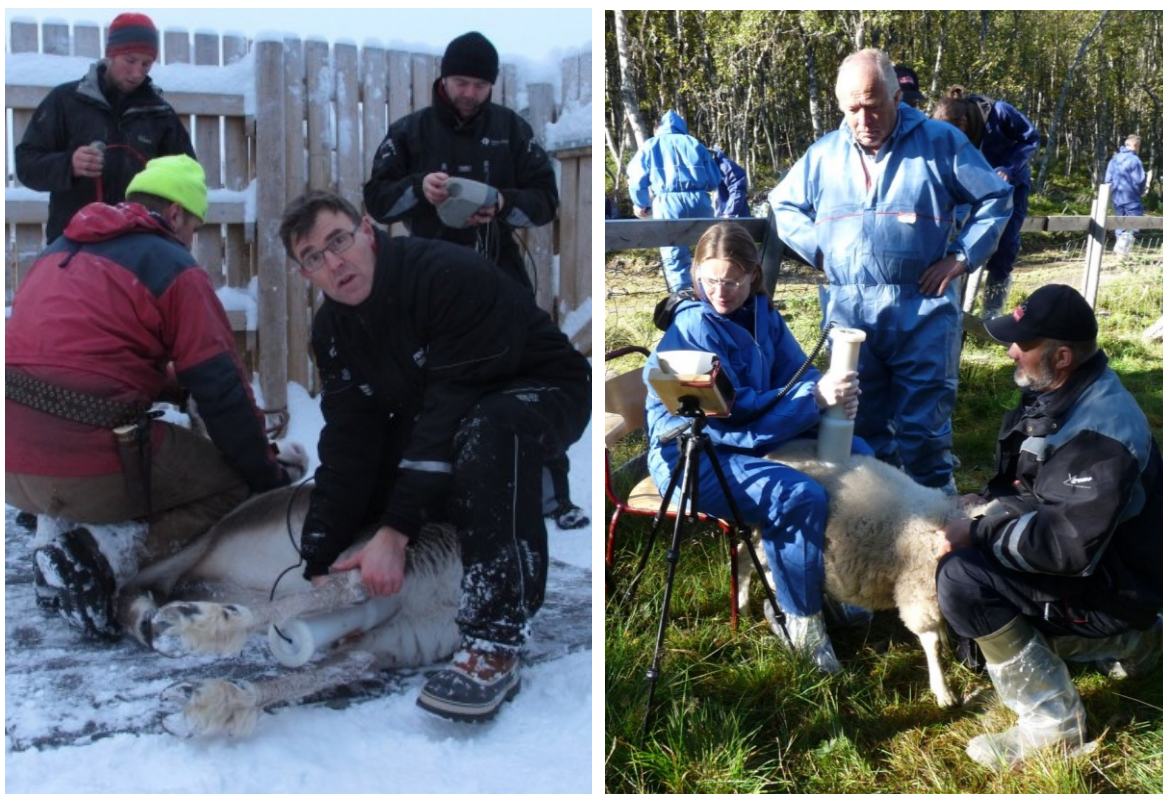
Figur 3.6. Kontroll av radioaktivt cesium blir gjort med måling mellom bakbeina på reinsdyr og bakre del av ryggen på sau. (Foto rein: Torild A. Østmo/Mattilsynet; sau: Strålevernet)
