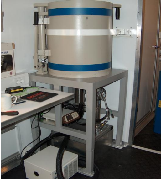
Instrument for gammamålinger montert i blyskjerming.
