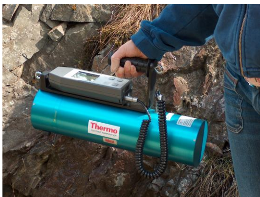
Doseratemåler påmontert probe for separasjon av variasjon i naturlig bakgrunnsstråling fra menneskeskapt forurensning.
