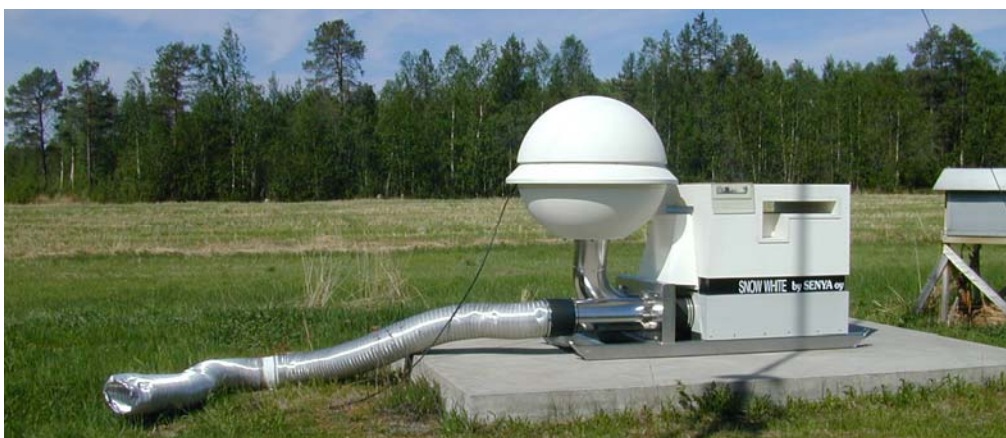
Воздухофильтрующая установка подразделения аварийной готовности НРПА в Сванхове, Финнмарк Фото: НРПА).
