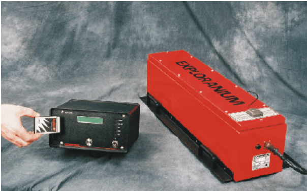
En 4 liters NaI-detektor med spektrometer (foto: Science Applications International Corporation (SAIC)).
