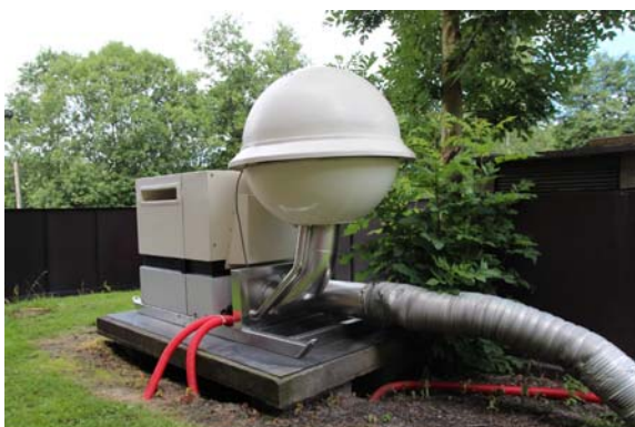
Ein av fem luftfilterstasjonar i Noreg som overvakar lufta for radioaktivitet. Foto: Statens strålevern.
