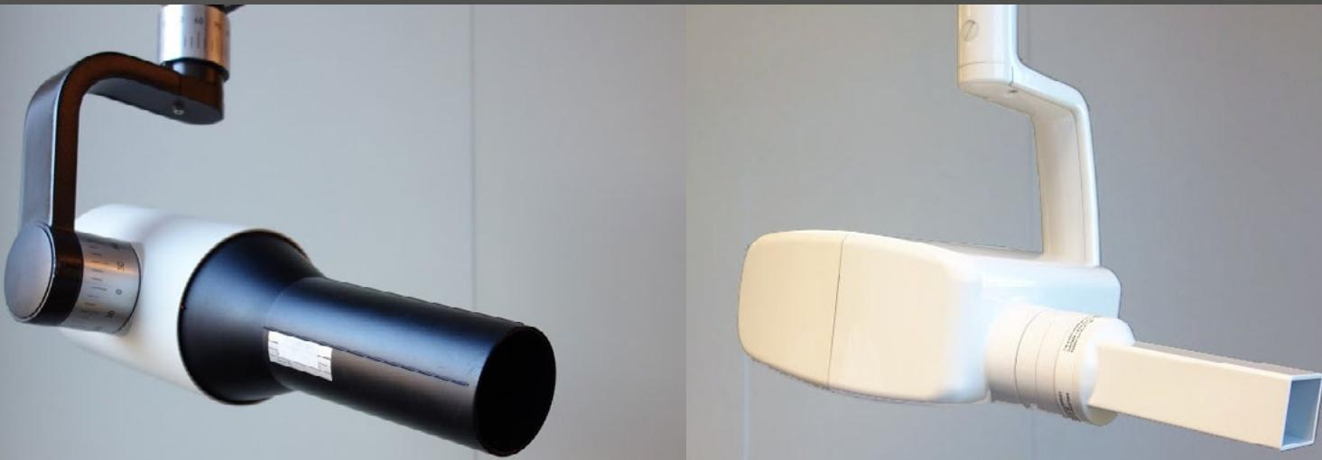
Røntgenapparat med henholdsvis rund (venstre) og rektangulær (høyre) kollimering. Rund kollimering gir et rundt strålefelt, mens rektangulær kollimering gir et firkantet strålefelt. Foto: Det odontologiske fakultet, UiO.
