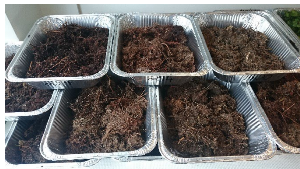
På laboratoriet blir jordprøvene tørket i tørkeskap, siktet og lagt i egne prøvebokser før de er klare for radioaktivitetsmålinger.
