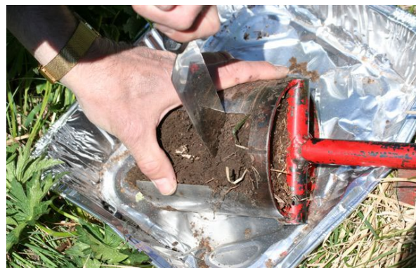
Bare de øverste 3 cm av jorden bli beholdt til prøven. Koordinater skrives ned og hver prøve legges i egne papirposer for oppbevaring til de ankommer laboratoriet.
