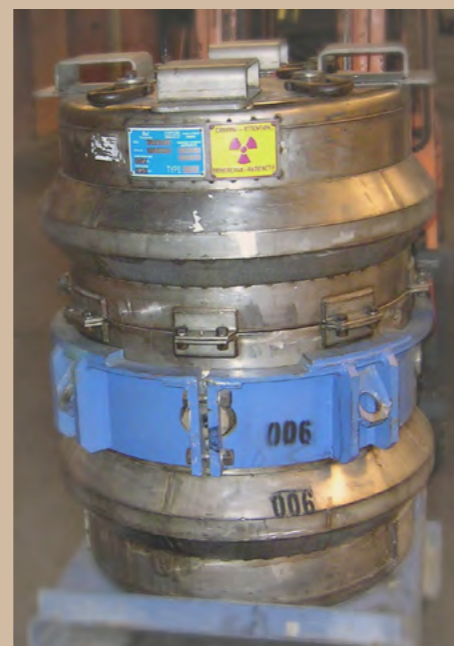
Radioaktiv kilde fjernet fra blodbestrålingsanlegg og plassert i en transportbeholder. Foto: Nerliens Meszansky
