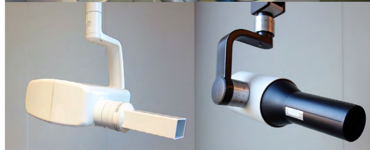
Røntgenapparat med rektangulær (til venstre) og rund (til høyre) kollimering. Rund kollimering gir et rundt strålefelt, mens rektangulær kollimering gir et firkantet strålefelt. Rektangulær kollimering gir lavest stråledose til pasient, fordi det gir et mindre strålefelt. Foto øverst: Strålevernet, nederst Det odontologiske fakultet, UiO.
