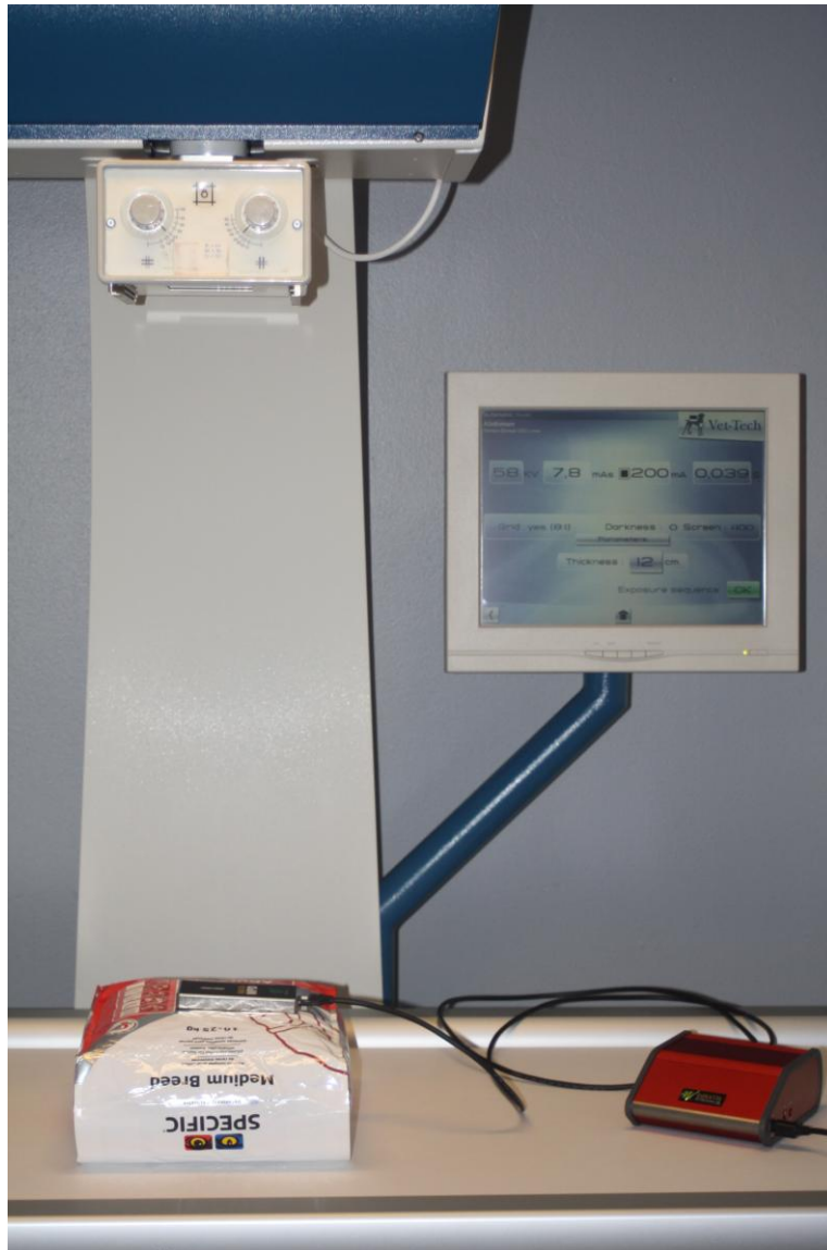
Bilde 4-1 Eksempel på oppsett for måling av inngangsdose ifm veterinærrøntgen
