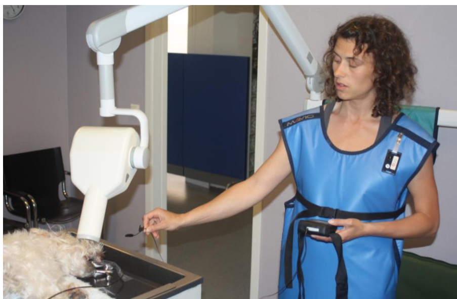
Bilde 4-2 Måling av spredt stråling ved tannrøntgen undersøkelse av hund.
