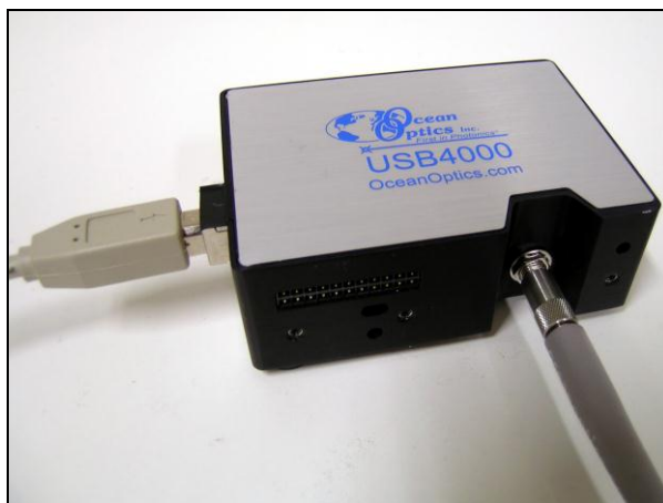
Et Ocean Optics USB4000-UV-VIS miniatur fiberoptisk CCD-spektrometer med en Bentham D7-CAL Teflon diffusor koblet til en bærbar PC ble brukt til måling av UV-strålingen i alle ulike solariemodeller og rørkombinasjoner. Se Appendiks D for flere detaljer om måleinstrumentene.
