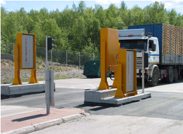
Portalen med måleinstrument ved grensestasjonen på Storskog i Finnmark (foto: Strålevernet).
