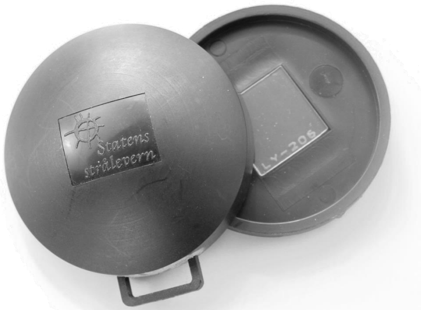
Bilde 10: Sporfilmer (CR-39) fra Strålevernets eget laboratorium ble brukt i kartleggingen. Foto: Statens strålevern.
