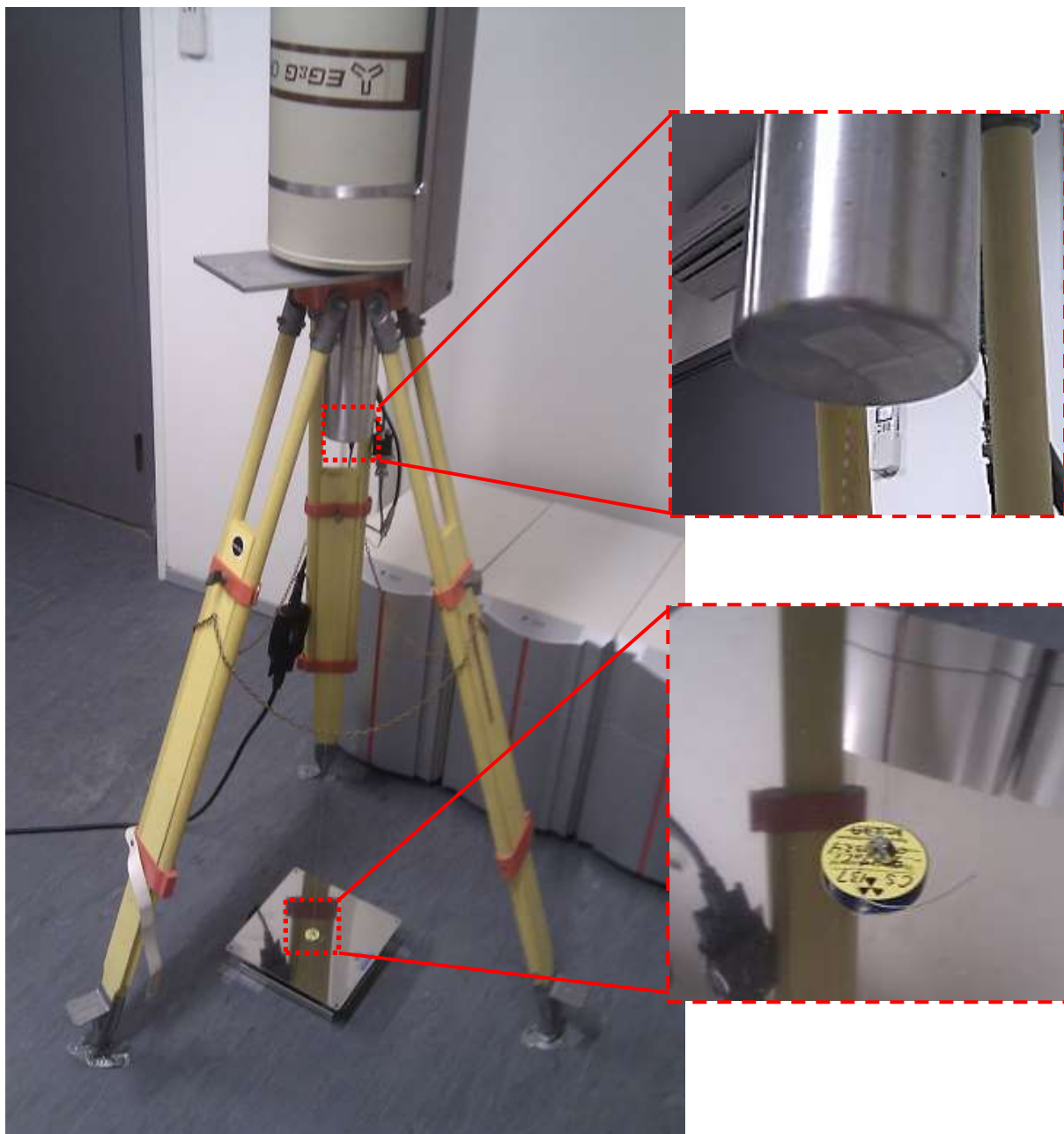
Figur 8 Oppsett for måling av detektorens respons ved normal insidens. En distanse på 100 cm mellom punktkildens og detektorens overflatens ble målt opp ved hjelp av en vektet snor festet midt på endcap.
