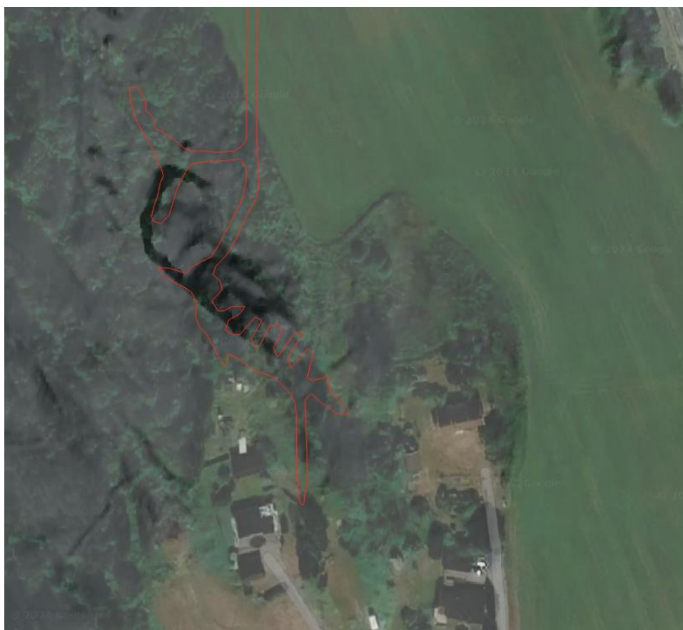
Figur 2. Åpning i dagen, med strosserom. Rød linje viser gruvegangen under strosserommene.
